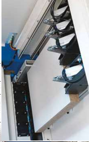
Spirofore pannelli con pinze pneumatiche Panels pusher with pneumatic pins Alisador de tables con pinzas neumáticas Plattenstecher mit pneumatischen Spannanzgen Pousseur panneaux avec pinces pneumatiques
