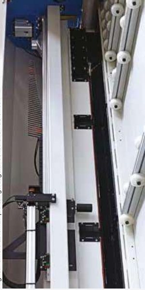
Accostatore automatico posteriore su guida con pattini a ricircolo di sfere. Automatic rear aligner on guide with recirculating ball bearings Alisador tras automático sobre guía con recirculación de bolas Automatischer hinterer Ausrichter auf Führungen mit Kugelzirkulations-Gleitblöcken Aligneur arrière automatique sur guidage à recirculation de billes.
