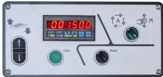
Positionneur avec fonction manuelle et automatique (opt. pour SP 530 PRO)
