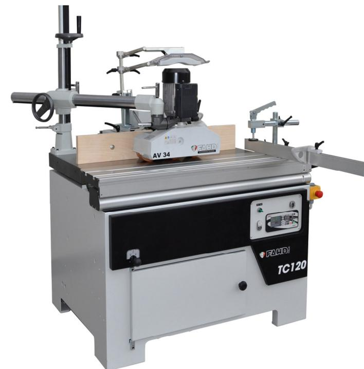
*TC 120 – Soulevement et inclinaison motorisé géré par panneau de contrôle VK3, avec entraineur AV34*
