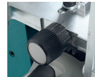
Réglage micrométrique de la position du moteur
