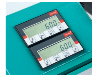
Affichage digital de la hauteur et de la position de la rainure
