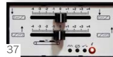
37 Controllo per tampone temporizzato Pad time-control device Bedienung für einsatzgesteuerten Schuh Commande pour patin temporisé Control para tampón temporizado
