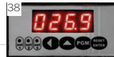
38 Visualizzatore elettronico Quota Electronic digital read-out Elektronische Digitalanzeige Arbeitsmass Visualisation de la cote électronique digitale Visualizador de cota electrónico digital
