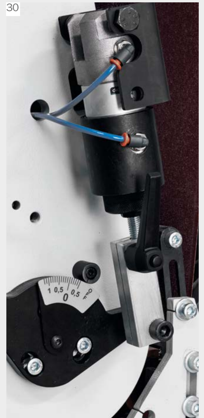
30 Esclusione pneumatica rulli da quadro comando Pneumatic roller cut-out from control panel Pneumatische Walzenausschließung auf dem Steuerpult Exclusion pneumatique rouleaux depuis tableau de commande Desactivación neumática rodillos desde cuadro de mando
